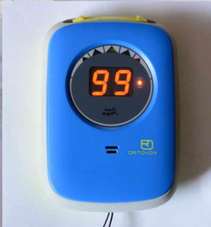
L'appareil réalise alors l'auto-test de ses antennes pendant 20 secondes
