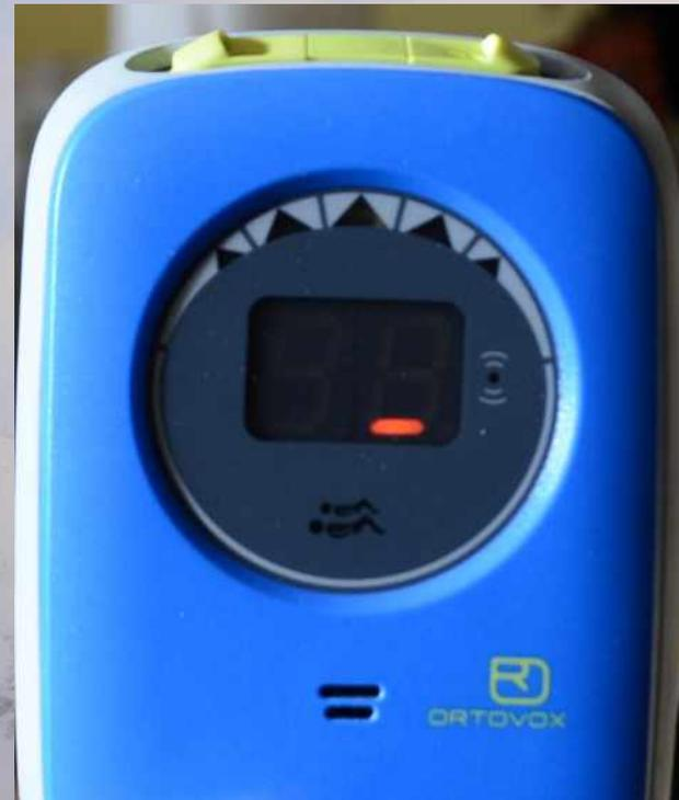
Position verticale, le DVA émet sur l'antenne
